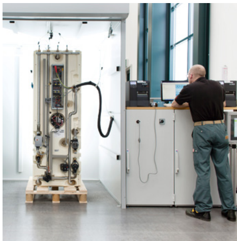
Jeder einzelne Kombispeicher wird elektrisch und hydraulisch vor Auslieferung geprüft.
