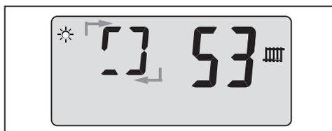
È possibile interrompere l'antipendolamento con il tasto [reset].
