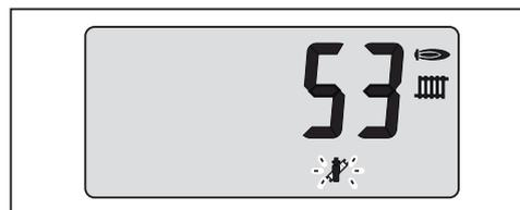
Innerhalb dieser Zeit kann in der Heizungsfachmann-Ebene durch Drehen vom Drehrad der Zeitablauf der 2 Minuten neu gestartet werden. Dies bietet die Möglichkeit in der Info-Ebene Anlagenwerte bei entsprechender Leistung abzufragen.
