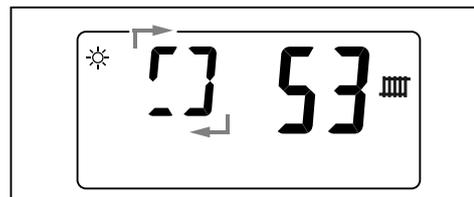
Die Brennertaktsperrn kann mit der Taste [reset] abgebrochen werden.
