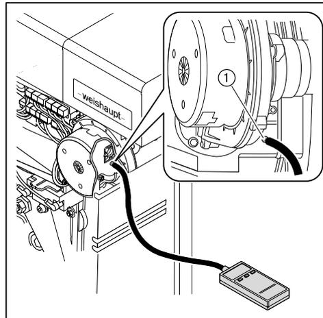
Öldruckmessgeräte an Ölpumpe
