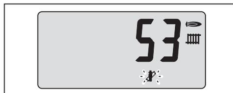
Durant ces 2 minutes, il est possible de relancer ce temps de fonctionnement pour 2 minutes dans le menu installateur en actionnant le bouton rotatif. Ce qui permet de consulter instantanément les valeurs de l'installation dans le menu Info à une puissance donnée.
