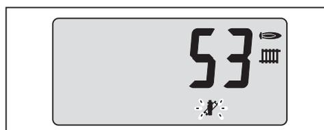
Innerhalb dieser Zeit kann in der Fachmann-Ebene durch Drehen vom Drehrad der Zeitablauf der 2 Minuten neu gestartet werden. Dies bietet die Möglichkeit in der Info-Ebene Anlagenwerte bei entsprechender Leistung abzufragen.
